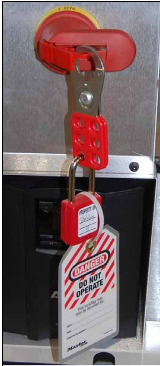
Figure 2-15: Pestaña de Bloqueo con Aldaba, Candado y Etiqueta
