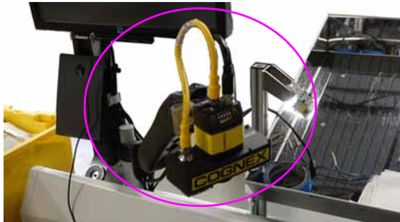
Figure 3-8: Cámara de Escaneo Simple
