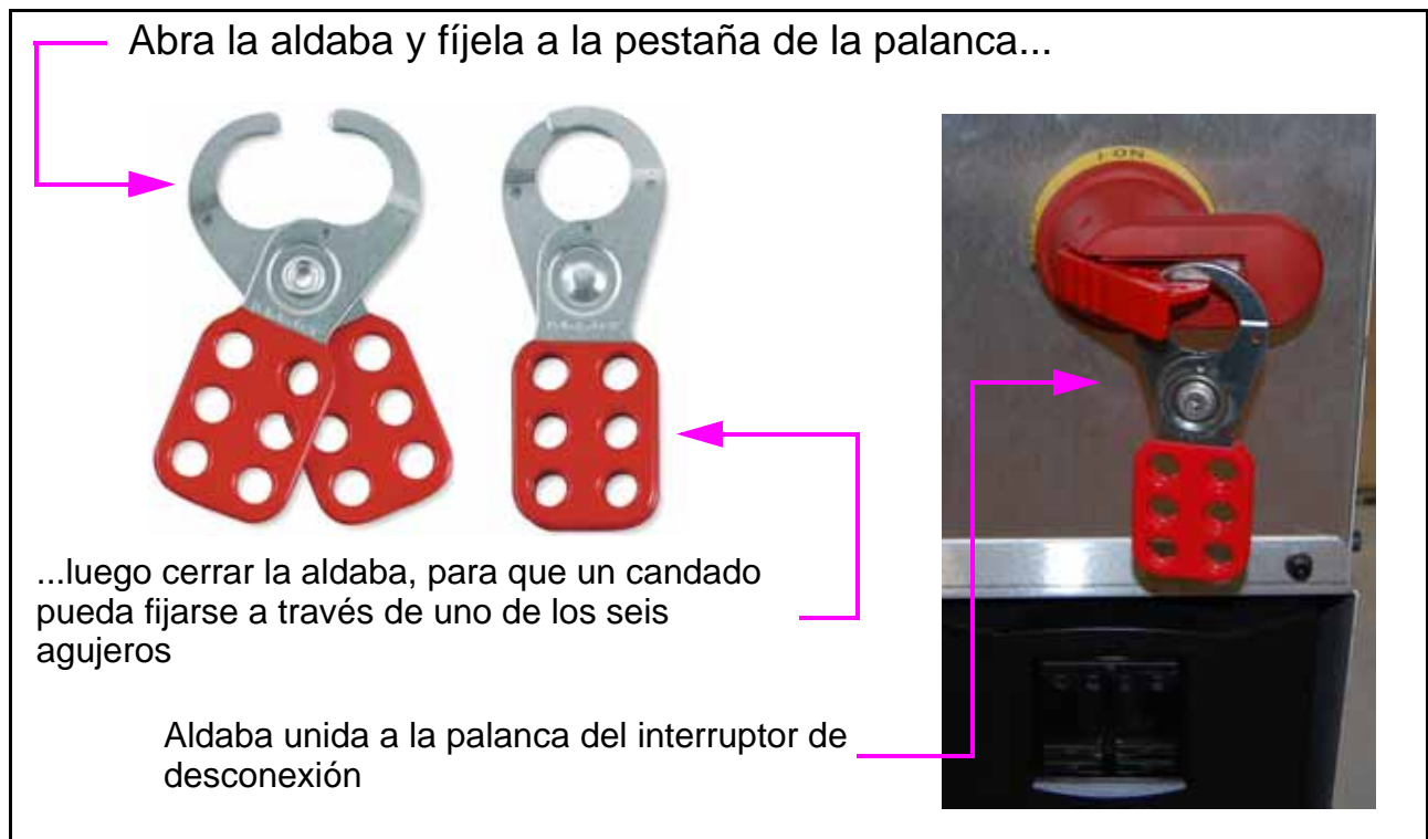
Figure 2-14: Detalle de la Aldaba
