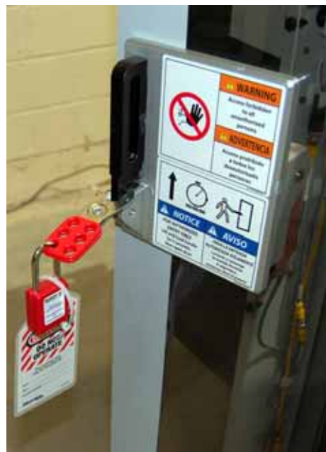
El Empleado Autorizado ha insertado una aldaba, una cerradura y una etiqueta en el pestillo
