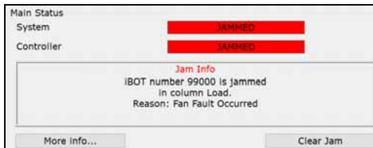
Figure 4-17: Atasco por Falla del Ventilador
