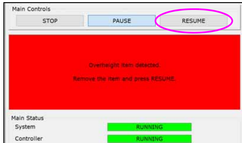
Bild 4-23: Warnung für Erkennung eines überhohen Objekts
