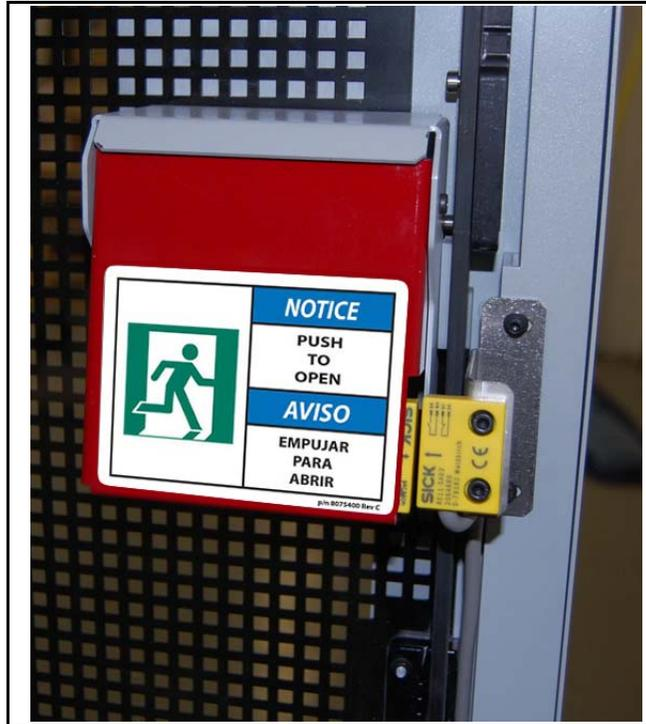
**Figura 2-6: Alavanca de Saída de Emergência (Saída)**
