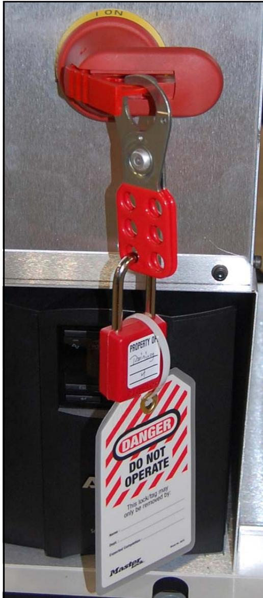
**Figura 2-15: Lingueta de Bloqueio com uma Trava de Segurança, Cadeado e Etiqueta**
