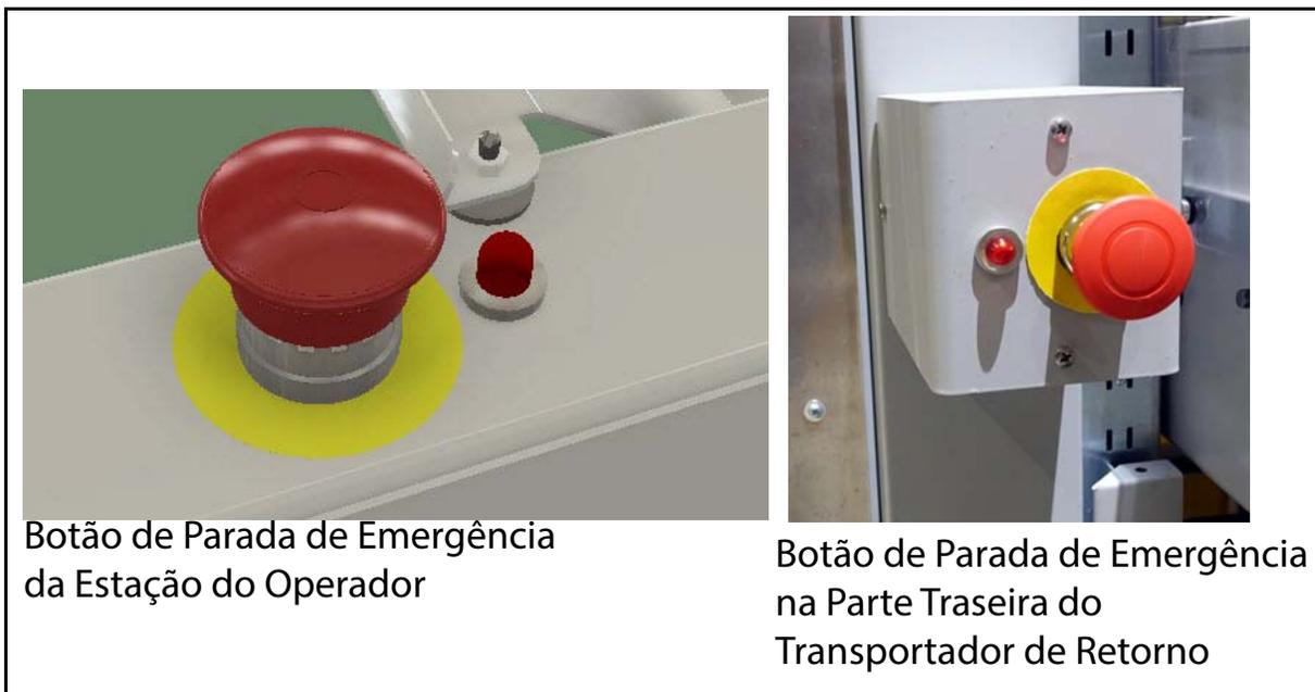
**Figura 2-1: Botões de Paradas de Emergência da Sure Sort**
