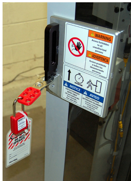
管理者がドアラッチに掛け金、ロック、タグを挿入したところ。
