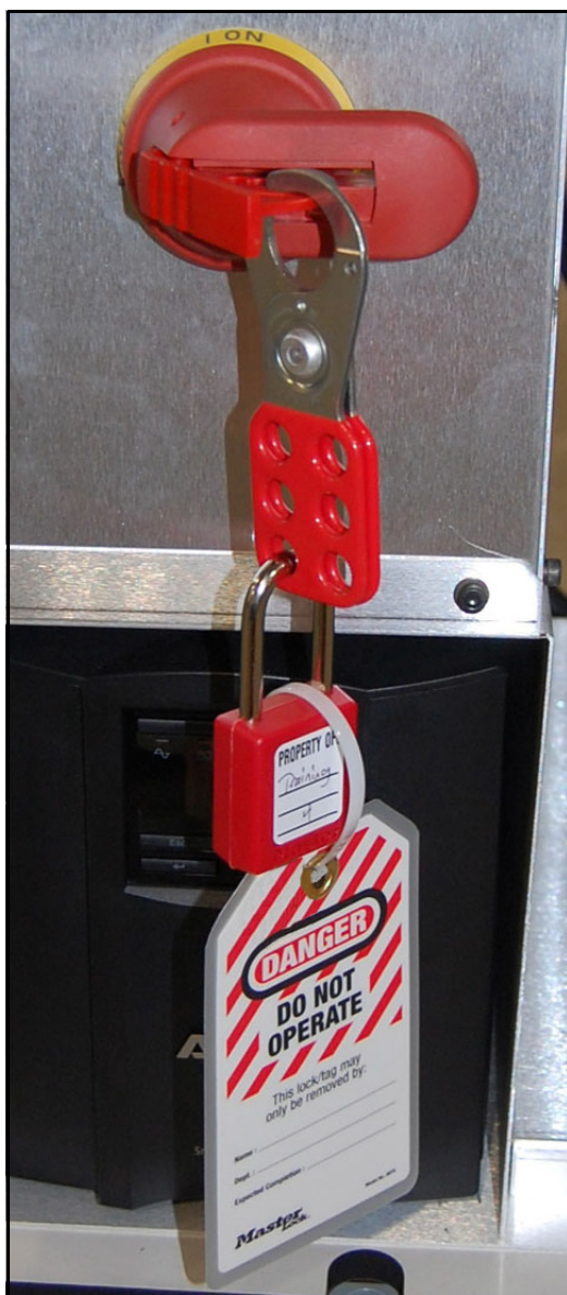
図 2-15: 掛け金、錠前、タグ付きのロックアウトタブ
