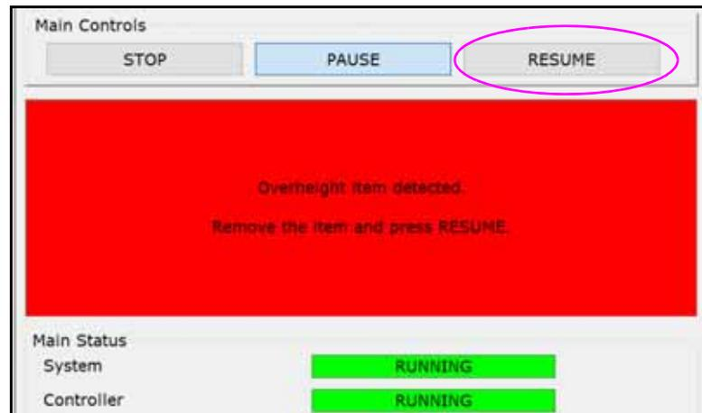
**Figure 4-23: Advertencia Elemento con Exceso de Altura Detectado**
