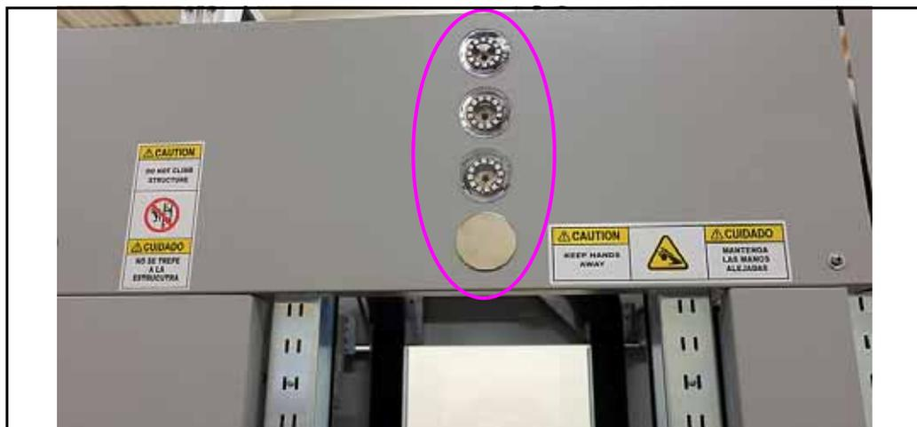
**Figure 3-7: Función de Luz de Freno**
