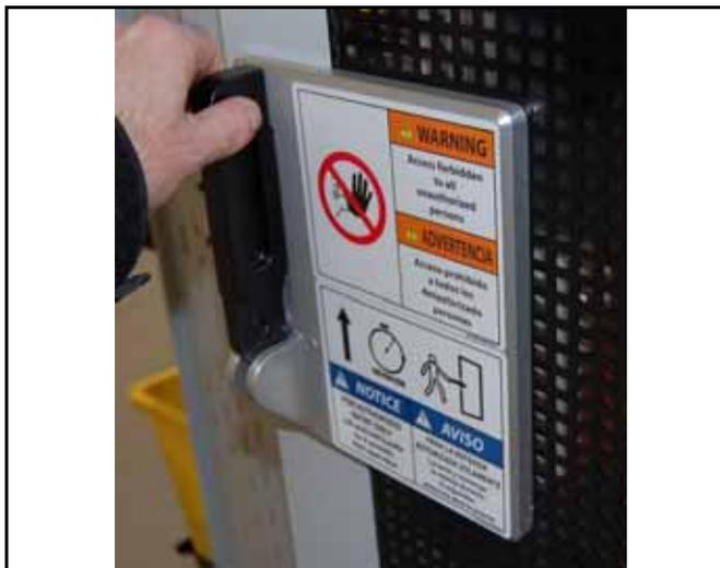
**Figure 2-18: Detalle del Enclavamiento de la Puerta**
