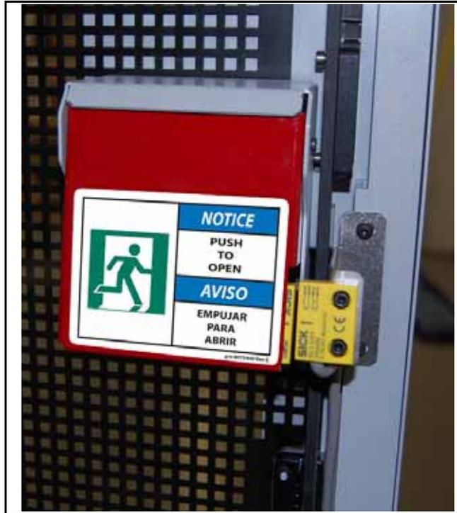
**Figure 2-6: Palanca de Salida de Emergencia (Egreso)**
