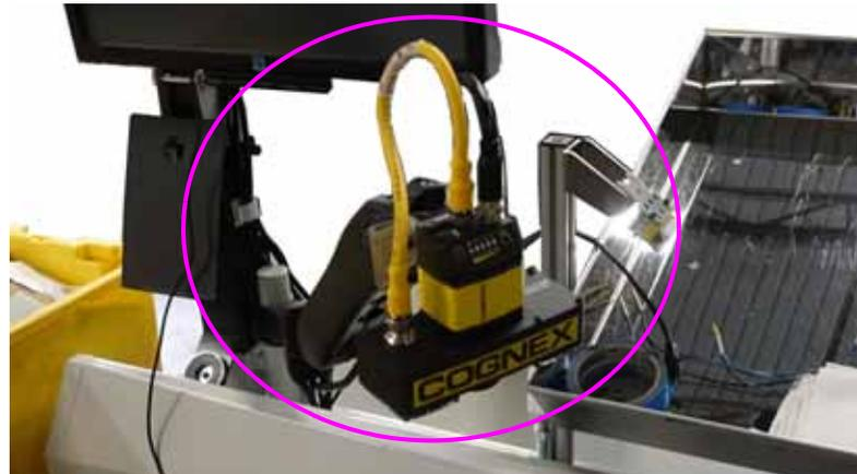
**Figure 3-8: Cámara de Escaneo Simple**
