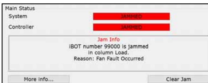
**Figure 4-17: Atasco por Falla del Ventilador**
