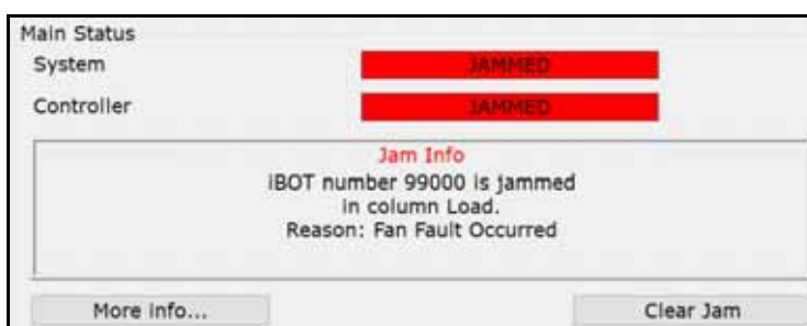
Figure 4-17: Atasco por Falla del Ventilador
