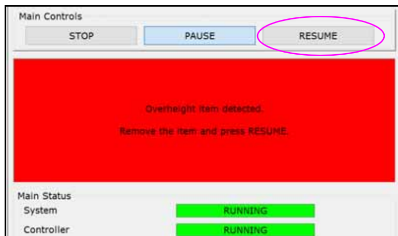
Figure 4-23: Advertencia Elemento con Exceso de Altura Detectado
