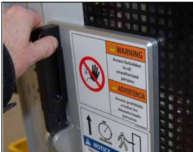
Figure 2-18: Detalle del Enclavamiento de la Puerta
