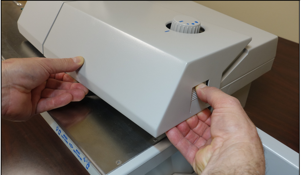
図 2-9: 上部カバーを取り外すと連動安全装置システムが起動
