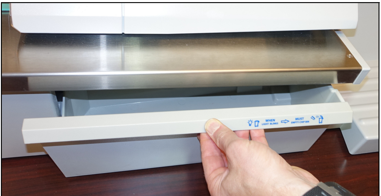
図 2-10: ゴミ箱トレイを取り外すとインターロックシステムが起動
