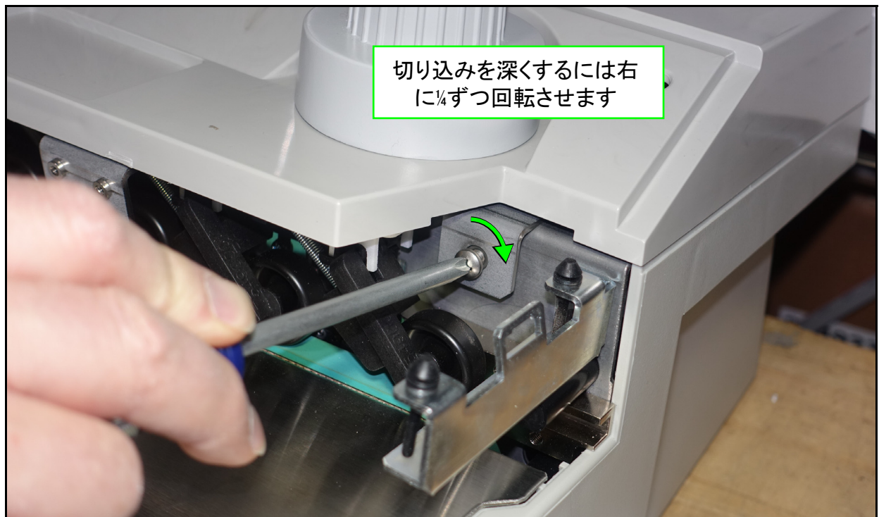
図 4-20: 切り込み深さの調整
