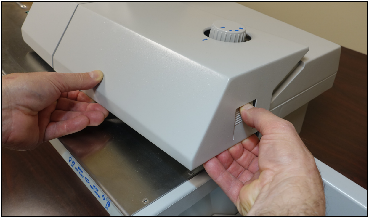
Figure 2-9 : Déclenchement de l'interverrouillage en cas de retrait du couvercle supérieur
