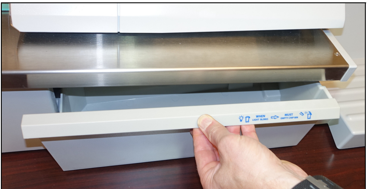
Figure 2-10 : Déclenchement de l'interverrouillage en cas de retrait du bac à copeaux
