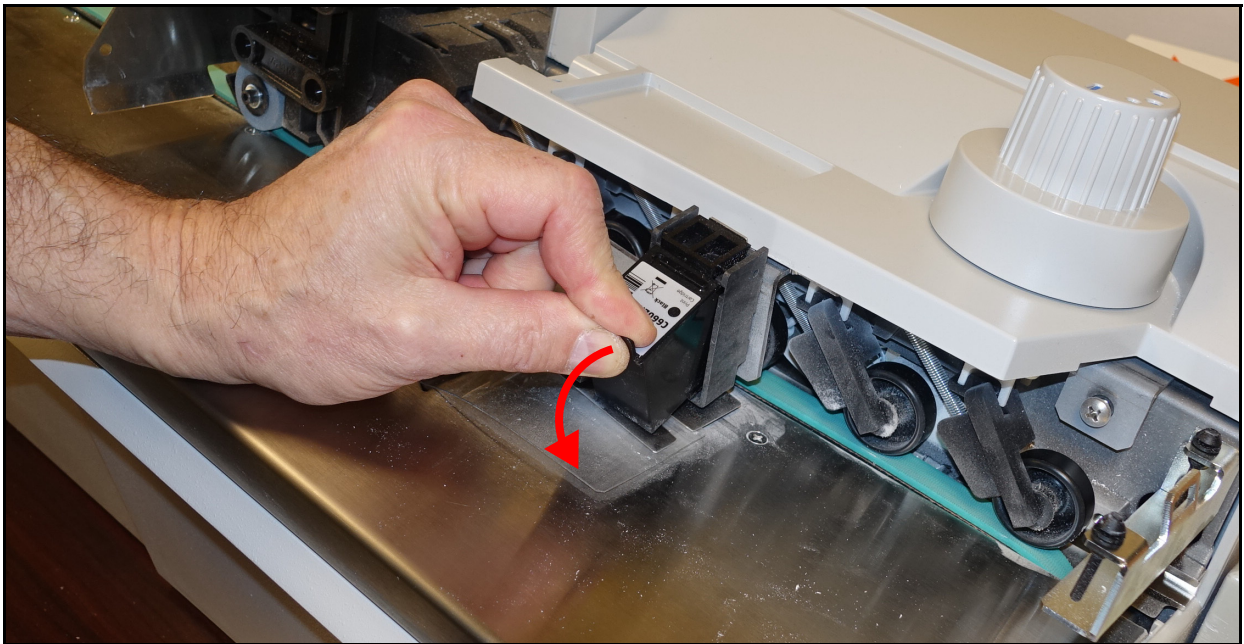
Abbildung 4-17: Entfernen der Druckerpatrone
