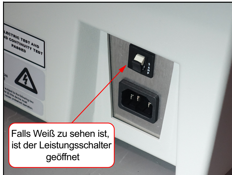
Abbildung 4-21: Geöffneter Leistungsschalter
