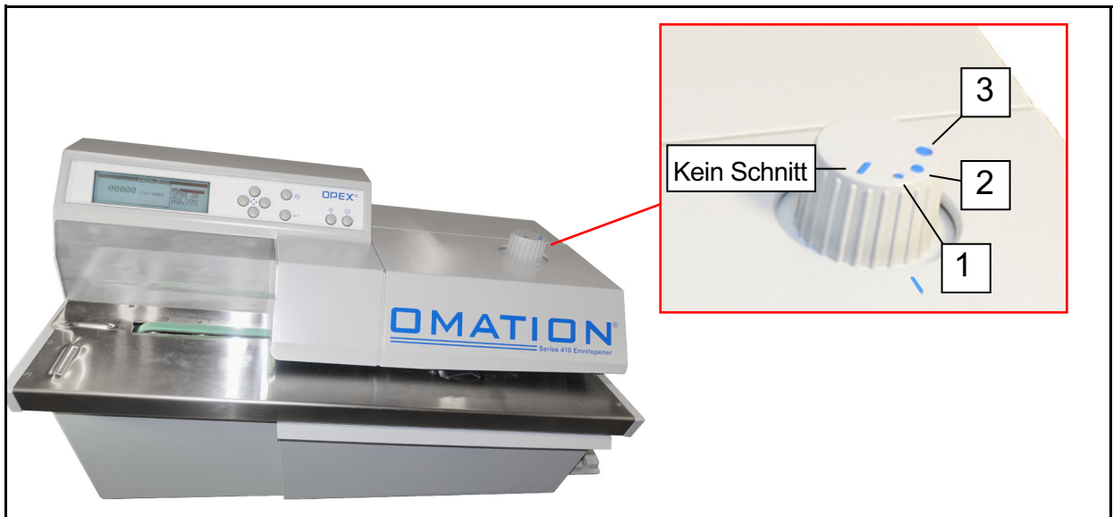
Abbildung 4-10: Einstellen der Schnitttiefe
