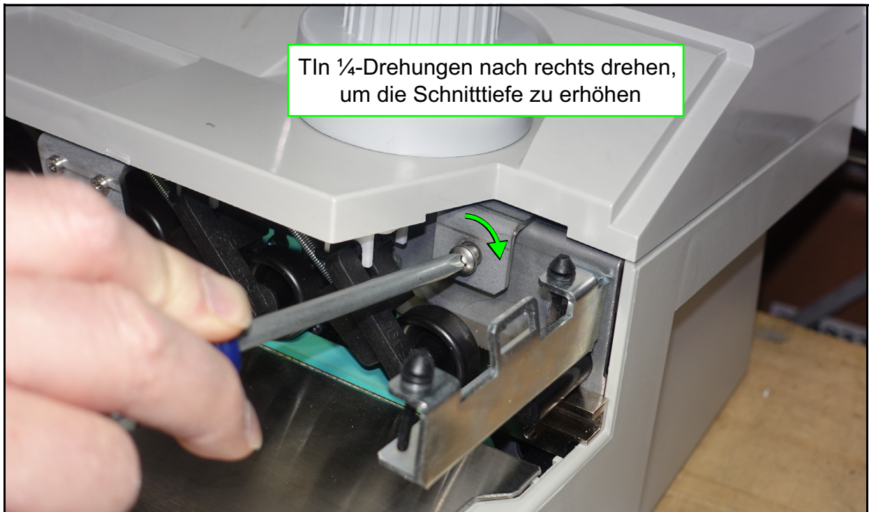
Abbildung 4-20: Einstellung der Schnitttiefe
