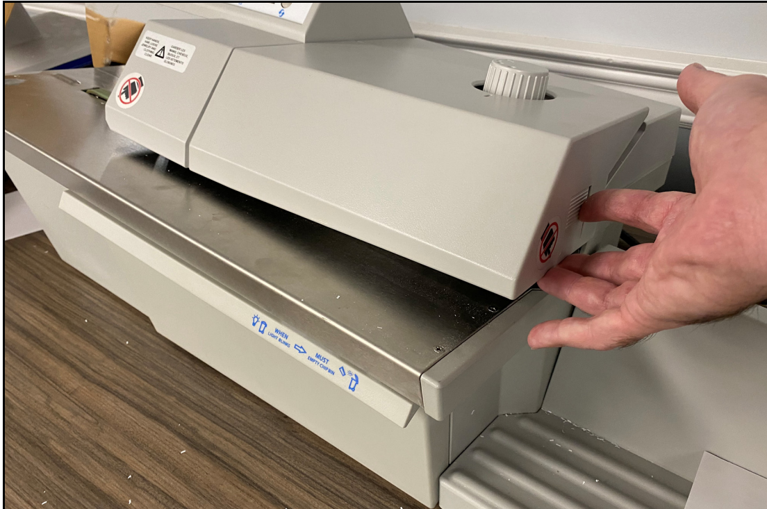
図 2-8 : 上部カバーを取り外すとインターロックシステムが起動
