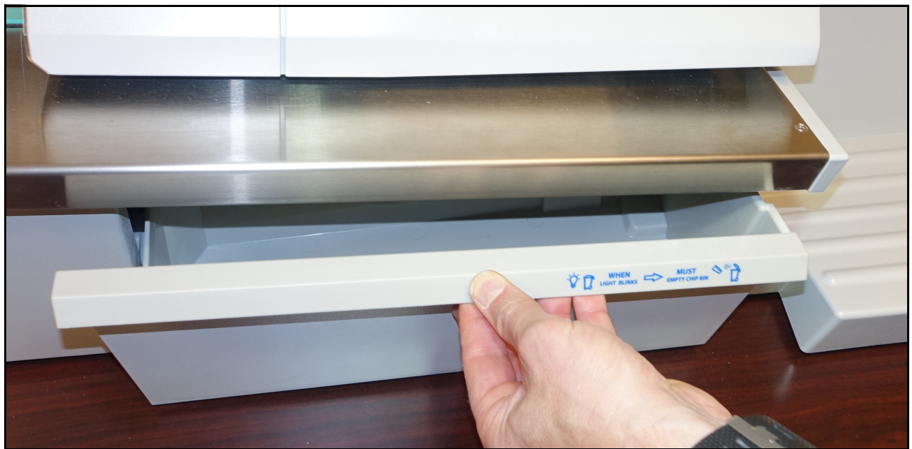
図 2-9 : ゴミ箱トレイを取り外すとインターロックシステムが起動
