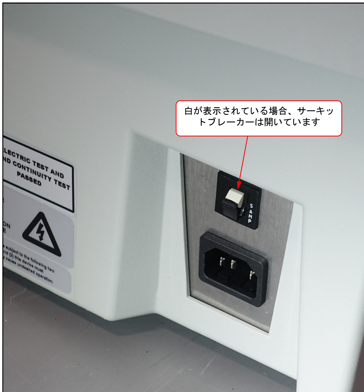
図 4-15 : サーキットブレーカーを開く
