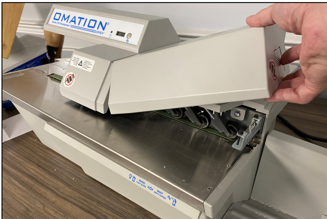
図 4-11 : ニップアームカバーを解除する
