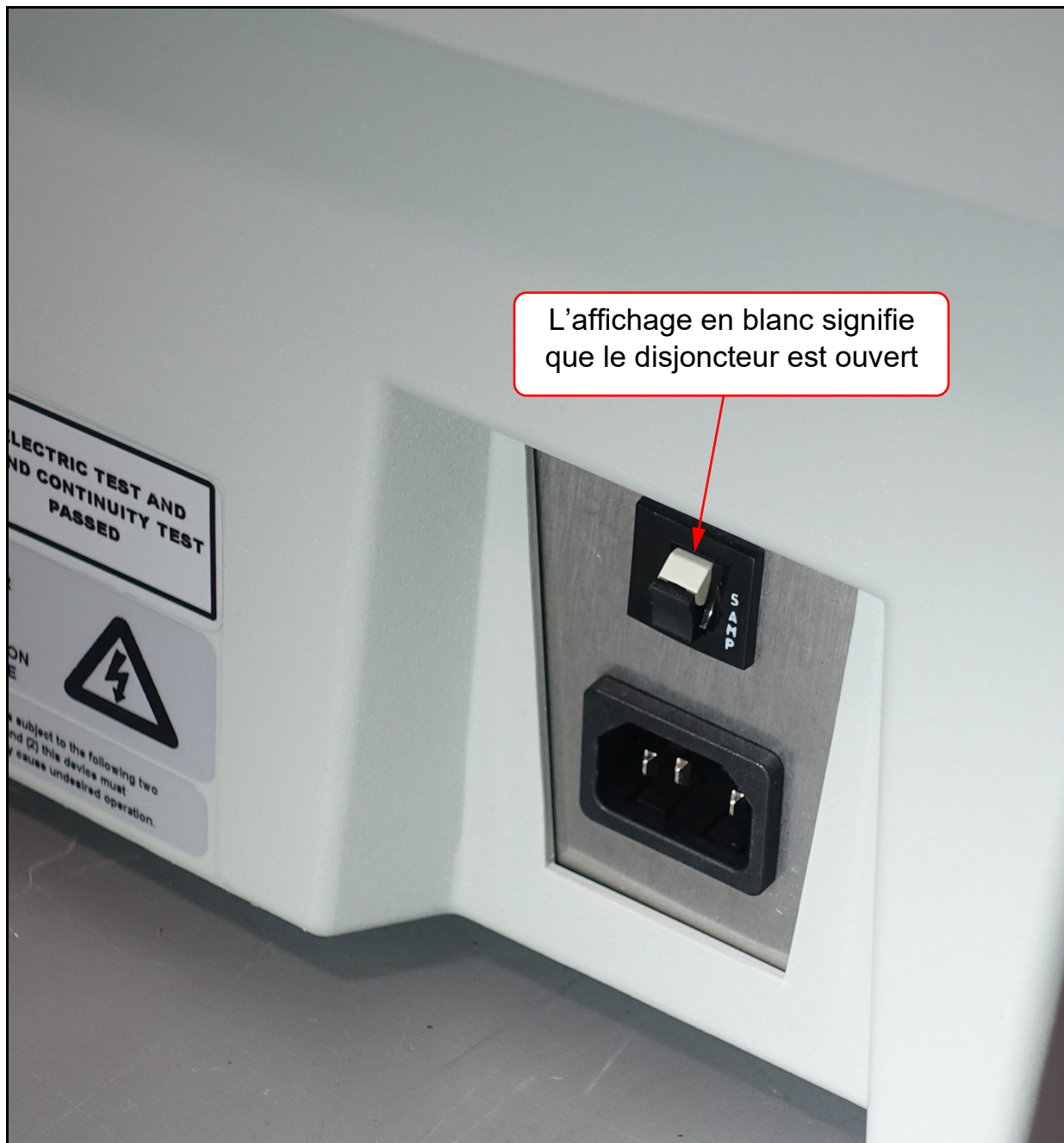
Figure 4-15 : Ouverture du disjoncteur
