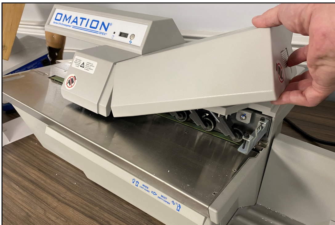
Figure 4-11 : Soulevez le couvercle du bras de pincement
