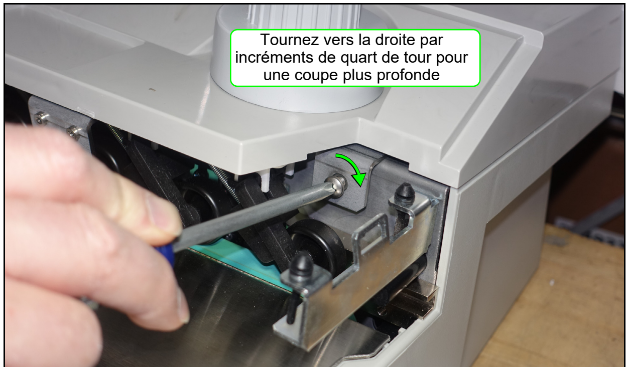
Figure 4-14 : Réglez la profondeur de la fraise
