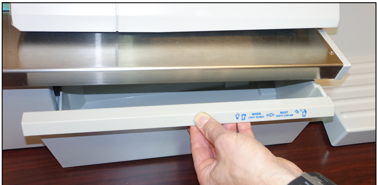
Figure 2-9 : Déclenchement de l'interverrouillage en cas de retrait du bac à copeaux
