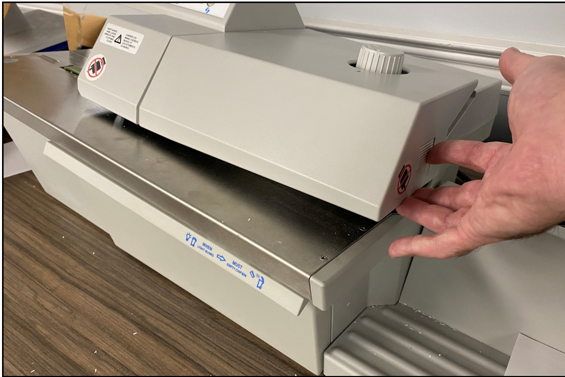
Figure 2-8 : Déclenchement de l'interverrouillage en cas de retrait du couvercle supérieur
