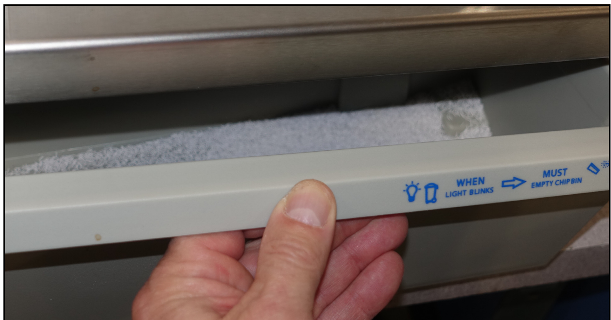
Figura 4-3: Apertura de la bandeja del recipiente de virutas
