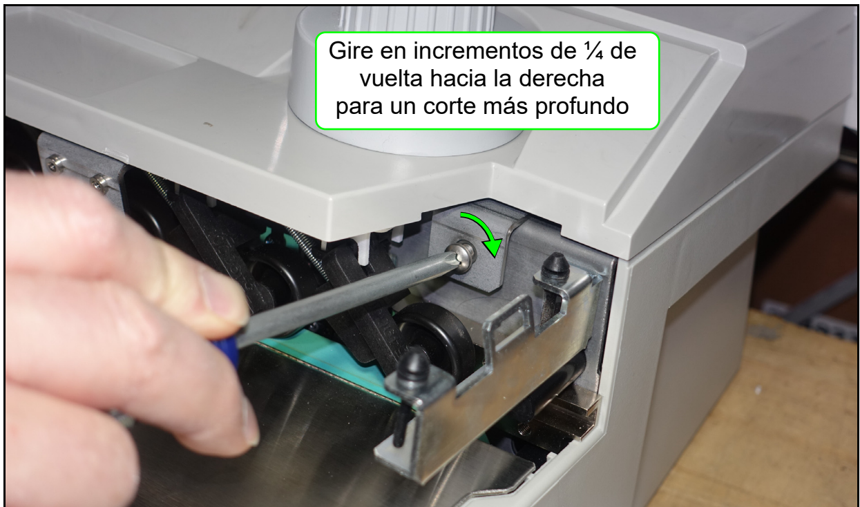
Figura 4-14: Ajuste de la profundidad de la cuchilla
