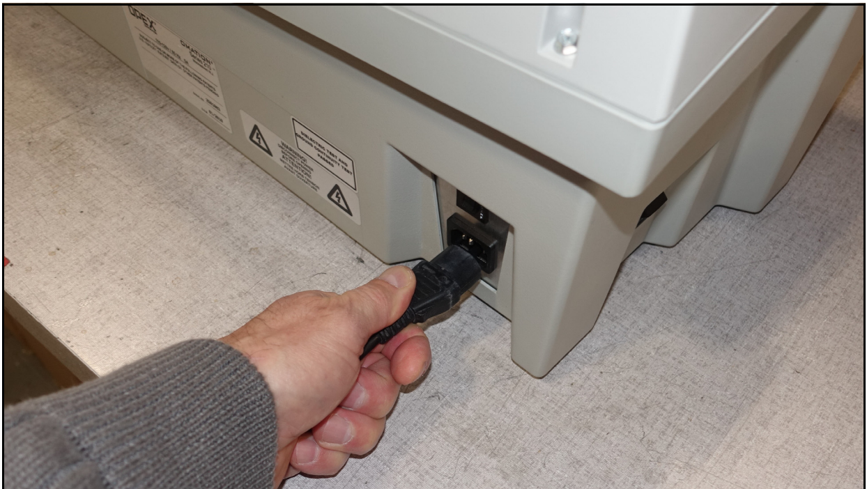
Abbildung 4-1: AC-Eingang an der Rückseite
