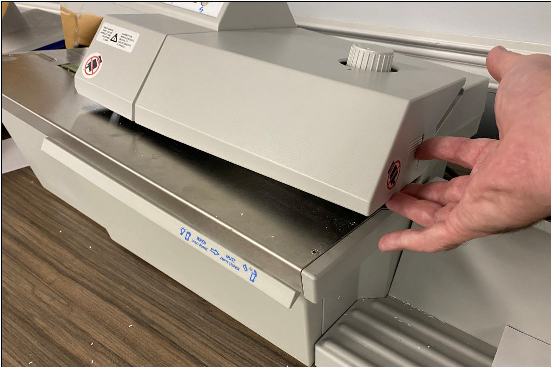
Abbildung 2-8: Auslösung der Verriegelung bei Entfernung der oberen Abdeckung
