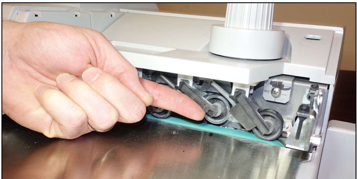
Abbildung 4-12: Reinigung unter den Walzenrollen
