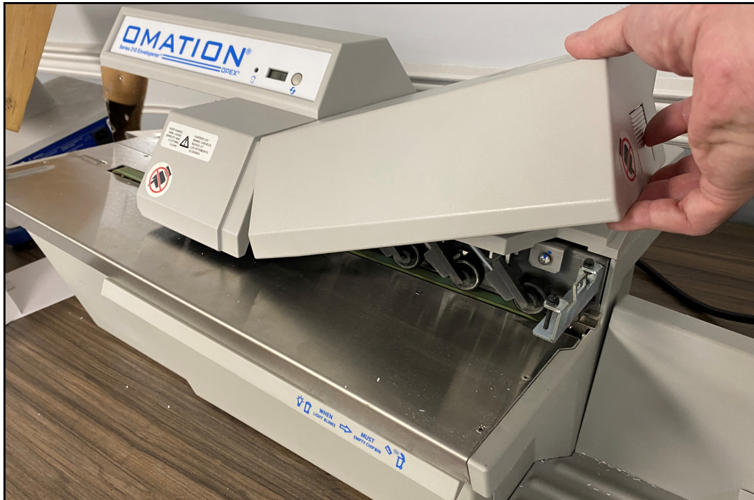
Abbildung 4-11: Anheben der Walzenarmabdeckung
