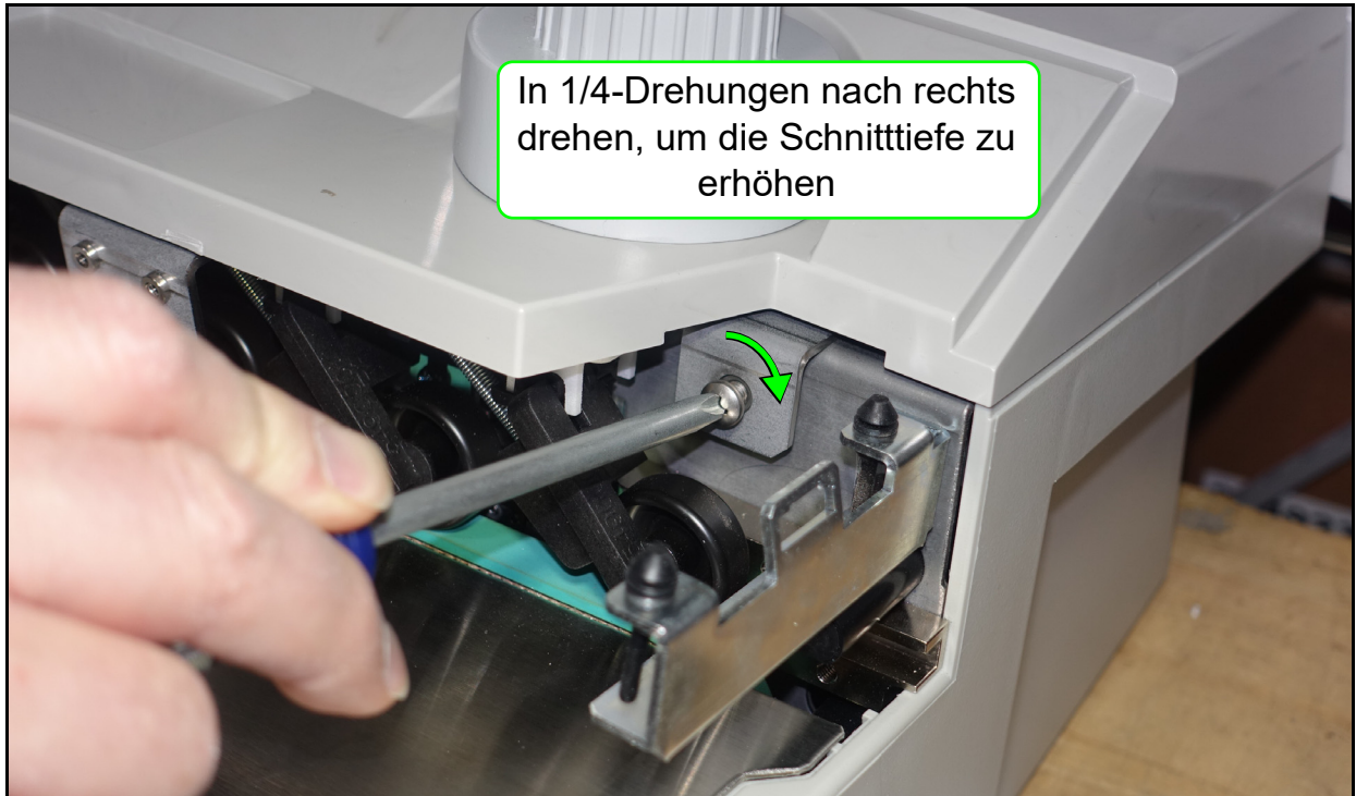
Abbildung 4-14: Tiefenjustierung der Schneidvorrichtung
