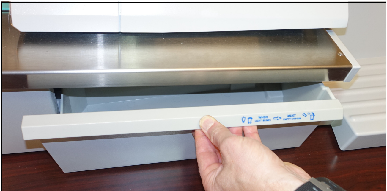
Abbildung 2-9: Auslösung der Verriegelung bei Entfernung des Fachs
