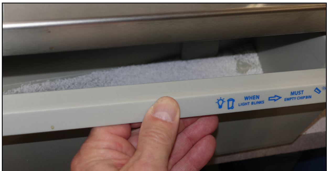
Abbildung 4-3: Öffnen des Schnipsel-fachs
