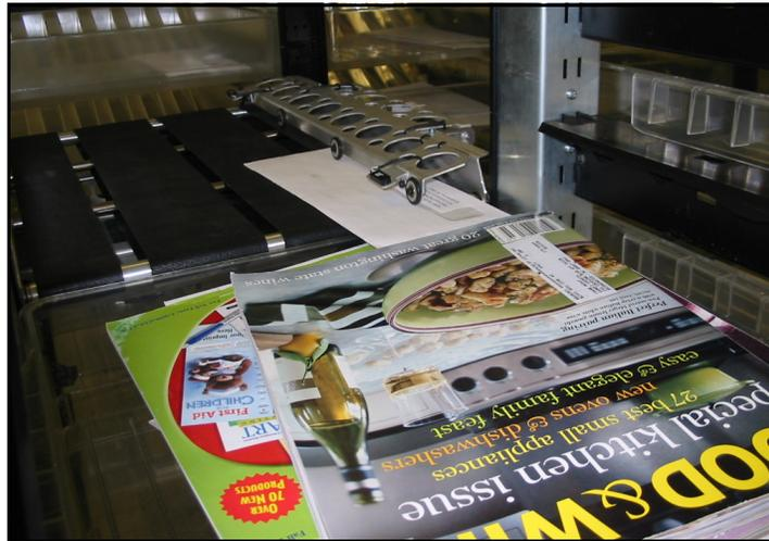
**Figure 150: Overfilled bin**
