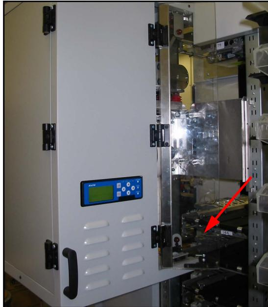
**Figure 148: Labeler door open**
