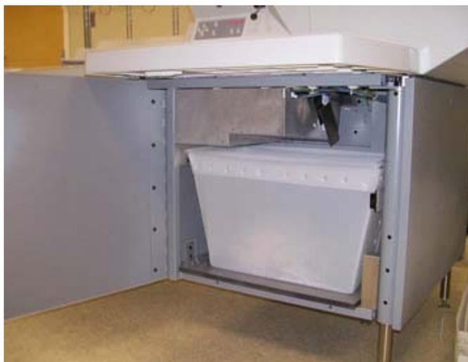
**Figure 6-4 : Emplacement de la corbeille à l'intérieur de l'armoire**
