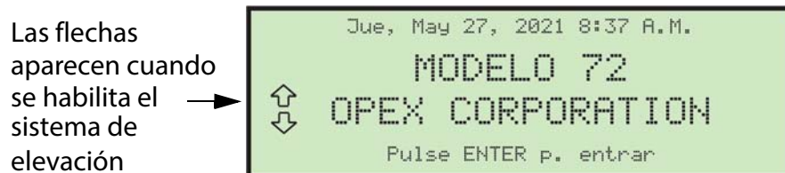
Figura 6-2: Sistema de elevación habilitado
