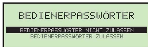
**Abbildung 5-38: Bildschirm „Bedienerpasswörter“**
