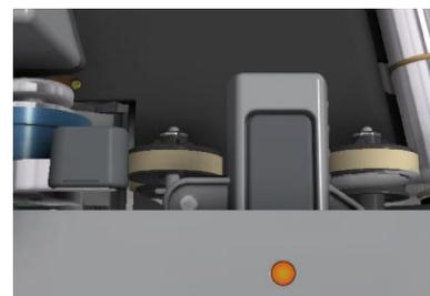
**厚さ測定装置 (TMD) の無効化** 厚さ測定装置を外すと、開いた紙の通り道ができるので、大きくて繊細なアイテムの処理に最適です。レバーを右（上矢印の位置）にスライドさせると、厚さ測定装置が外れます。ジョブに TMD が必要な場合は、オペレータに TMD が取り付けられていないことを示すプロンプトが表示され、オペレータは以下のいずれかを実行する必要があります。
