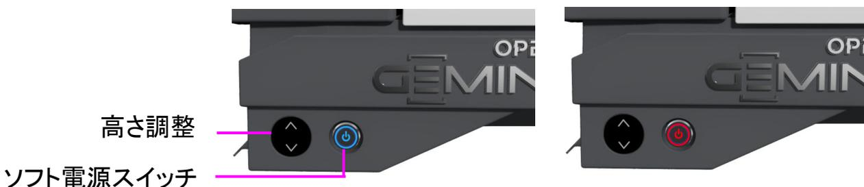
図 2-2 : 高さ調整とソフト電源スイッチ
