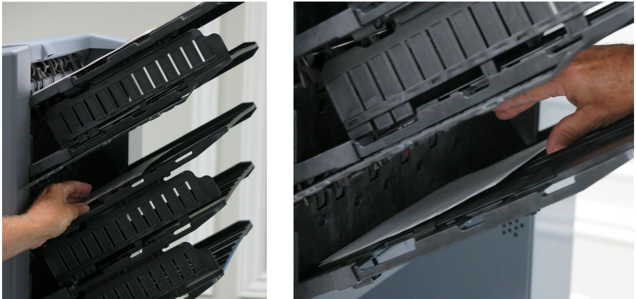
Figure 4-38 : Dégagement des bacs
