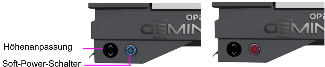
**Abbildung 2-2: Höhenanpassung und Soft-Power-Schalter**
