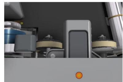
**Übersteuerung Dickenmessgerät (TMD)** Wenn das Dickenmessgerät (TMD) deaktiviert ist, entsteht ein offener Papierweg, der sich ideal für die Verarbeitung großer und empfindlicher Vorlagen eignet. Schieben Sie den Hebel nach rechts (Pfeil nach oben), um das Dickenmessgerät zu entriegeln. Wenn der Auftrag das TMD erfordert, wird der Bediener aufgefordert, anzugeben, dass das TMD nicht aktiviert ist, so dass er entweder:
