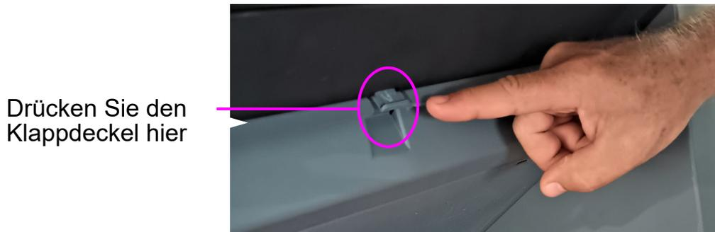
**Abbildung 5-5: Zugang zum Vorderseitendrucker**
