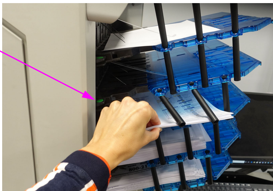
Figura 4-30: Vaciado de los compartimentos
